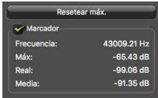
La frecuencia y los niveles de ruido (dB) en la ubicación del puntero del ratón se muestran en **Marcador**.
