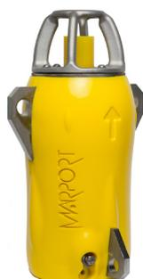
Un capteur de senne coulissante (ou bolinche) est installé sur la coulisse de la seine dans une protection robuste. Il transmet les données à la passerelle lors du filage et pendant la manoeuvre. Il émet des signaux acoustiques vers le bateau de manière omnidirectionnelle, ce qui évite toute perte de signal durant la manoeuvre.
