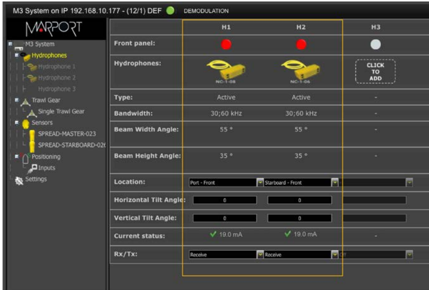
Illustration 6 : Configuration des hydrophones pour des capteurs d'écartement
